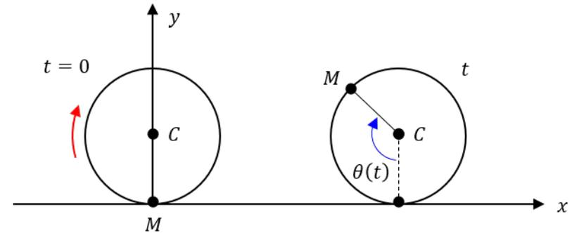
À l'instant initial, l'abscisse du point  $C$  est nulle. On note  $M$  le point sur la périphérie de la roue en contact avec le sol à l'instant initial. Le mouvement de la roue est paramétré par l'angle  $\theta(t)$ , l'angle entre  $\vec{CM}(t=0)$  et  $\vec{CM}(t)$ .
