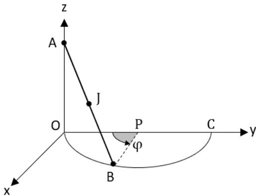
À l'instant initial  $t = 0$ ,  $B$  se trouve en  $O$ . À l'instant final,  $B$  se trouve en  $C$ . Le point  $B$  se déplace avec une vitesse angulaire  $\dot{\varphi} = \omega$  constante.
