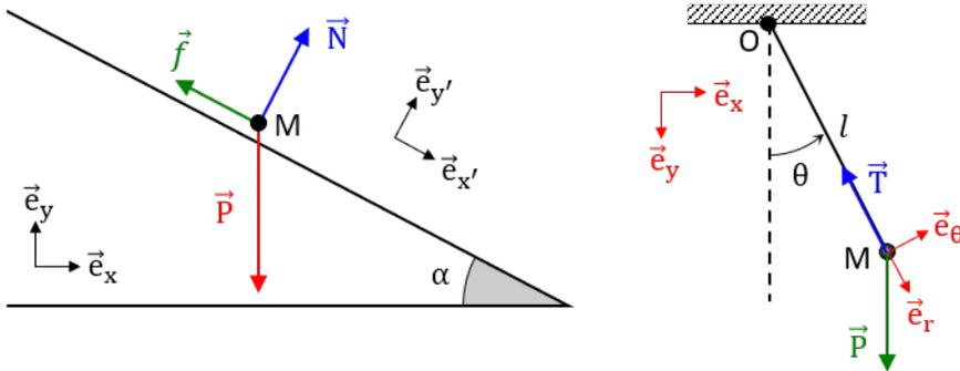
Schéma de gauche : Un point matériel M dévale une pente faisant un angle  $\alpha$  avec l'horizontale. Il est soumis à trois forces : le poids  $\vec{P} = -mg \vec{e}_y$ , la réaction normale du support  $\vec{N} = N \vec{e}_{y'}$  et les frottements  $\vec{f} = -f \vec{e}_{x'}$
